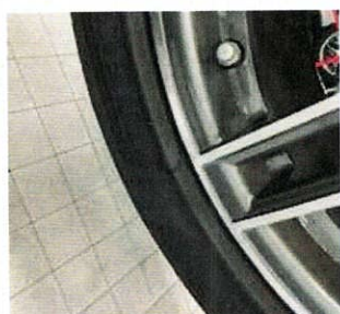
6.7.1 - Somnardäck Vänster Fram Skador däcksida
