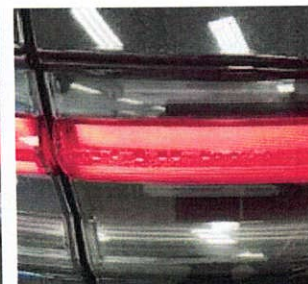
Skadebild Fukt i mittramp
